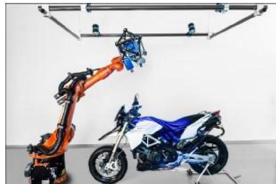
Abb. 1: Streifenlichtsystem auf Roboter mit zusätzlichem Sensor Tracking zur Erfassung der Sensorposition im Raum
